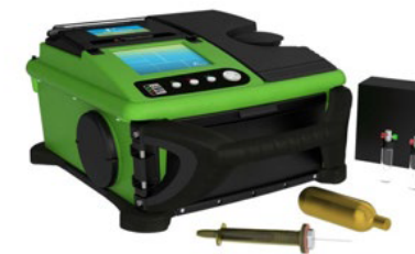
GC Torion® et technique de d'extraction des composés
